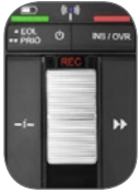
Schiebeschalter: Aufnahme, Stop, Wiedergabe, Rücklauf (LFH3010)
